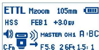
В режиме E TTL вспышка и камера будут совместно автоматически рассчитывать правильную экспозицию при съемке. При полном нажатии кнопки спуска сработает предварительная вспышка, используемая камерой для определения экспозиции и мощности вспышки непосредственно перед основным снимком.
